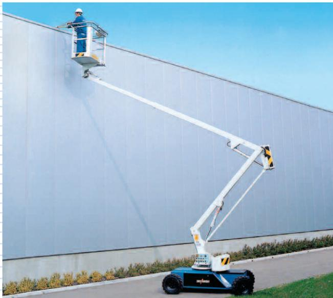
**Elévateur à nacelle, autotracté 120 ST**
