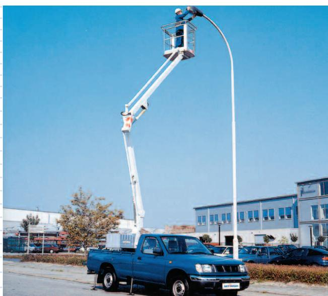
**Elévateur à nacelle monté sur Pick-Up 120 MC**
